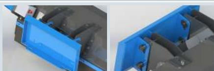
Sistema di attacco oscillante con perni asolati per pale cingolate compatte, per contenere peso che consente di assecondare e superare agevolmente i dislivelli del terreno.
