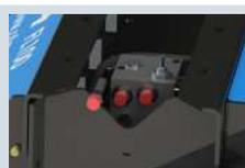
Fluidbox per una completa e sicura gestione del motore, con valvola di massima, sistema anticavitazione e regolazione di flusso per settare il numero di giri del rotore.
