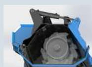
Cassa con doppio fondo per incrementare la robustezza e ottimizzare il volume di taglio, con rivestimento interno in Hardox.
