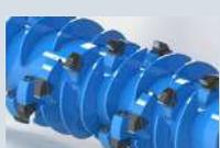
Di serie su FFHL riduttore di profondità di taglio che permette al rotore di mantenere un numero costante di giri e di preservare la vita dell'utensile.
