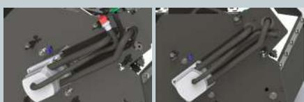
La macchina esce di serie in configurazione a due tubi, la fluidbox si occuperà di gestire il flusso di olio proveniente dal drenaggio del motore. Nel caso in cui la contropressione allo scarico sia maggiore di 8 bar è possibile prevedere il terzo tubo di drenaggio per lo scarico diretto del serbatoio.
