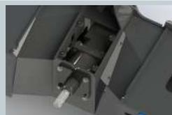
Motore idraulico orbitale dimensionato in base alla minipala. Montato su prolunga con cuscinetti per preservare la vita del motore.
