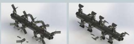
Rotore equipaggiabile con coltelli per una maggiore capacità di sminuzzamento e minore richiesta di potenza. Set di coltelli a due lame per A60-A80-A60R-A80R. Set di coltelli a tre lame per A90-A100-A90R-A100R. Rotore equipaggiabile con mazze per affrontare in sicurezza arbusti fino a 35mm di diametro.
