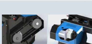
Motore a pistoni con drenaggio esterno di serie, protetto da carter nel caso di urti, supportato su prolunga con cuscinetti per evitare una prematura usura. Trasmissione a cinghia, indispensabile per applicazioni dove le potenze trasmesse iniziano a diventare consistenti, grazie alla funzione di giunto elastico che permette di preservare sia motore che il rotore da urti imprevisti. **Optional**: motore a pistoni cilindrata variabile meccanico e motore a pistoni cilindrata variabile automatico.
