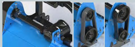
Trasmissione realizzata con scatola ad ingranaggi e cinghie, possibilità di invertire le pulegge per il funzionamento a 540 rpm o 1000 rpm.
