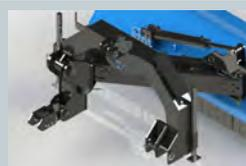
Arco a 3P realizzato in carpenteria saldata, in grado di sostenere tutte le sollecitazioni di una trincia serie laterale, Attacco a 3P in Cat.I e Cat.II.
