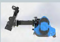
Arco a 3 punti con sistema di rotazione. Nel momento in cui il trattore sia costretto a percorrere un tracciato con variazioni repentine di pendenza, la rotazione dell'arco impedisce che la trincia venga schiacciata verso terra, limitando la compensazione con il sollevatore.
