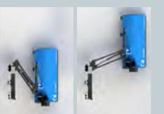
Il sistema con doppio braccio a parallelogramma permette di ottenere una traslazione laterale complessiva di circa 120cm, mentre in posizione di riposo la macchina risulta centrata rispetto l'attacco consentendo di ridurre al minimo l'ingombro della carreggiata durante il trasporto su strada.
