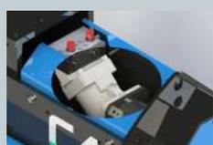
Motore a pistoni interno alla macchina per protezione da urti e detriti. Prolunga motore su cuscinetti per evitare una prematura usura. Trasmissione finale a cinghia con rapporto 1:1 per massimizzare la potenza trasmessa, grazie alla funzione di giunto elastico che permette di preservare sia il motore che il rotore da sollecitazioni impreviste.
