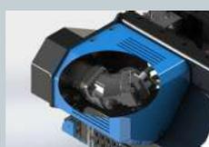
Motore a pistoni montato su prolunga con cuscinetti per evitare una usura prematura del motore, con carter per la protezione da urti. Trasmissione a cinghia, indispensabile per applicazioni dove le potenze trasmesse iniziano a diventare consistenti, grazie alla funzione di giunto elastico che permette di preservare sia il motore che il rotore da urti imprevisti.
