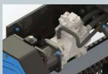
Motore a pistoni a cilindrata variabile, per una corretta erogazione della coppia in base alla richiesta di potenza. Quando il carico di lavoro si fa intenso, il sistema di controllo idraulico aumenta la cilindrata e di conseguenza la coppia, per far riacquistare giri al rotore evitando interruzioni del lavoro. Motore protetto dal telaio e montato su prolunga con cuscinetti. Trasmissione finale a cinghia di adeguata dimensione.
