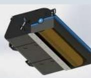
Rullo anteriore connesso alla benna di raccolta mediante cerniere per agevolare la pulizia della macchina. Con regolazione dell'altezza del rotore per garantire un ottimale funzionamento e compensare l'usura progressiva delle spazzole. Lama inferiore in Hardox sostituibile e reversibile.
