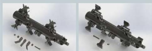
Rotore equipaggiabile con coltelli a tre lame per una maggiore capacità di sminuzzamento e minore richiesta di potenza. Rotore equipaggiabile a mazze per affrontare in sicurezza rami ed arbusti fino a 60 mm di diametro.
