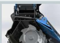
Cassa di spessore generoso per incrementare la robustezza e ottimizzare il volume di taglio. Rivestimento interno in Hardox.
