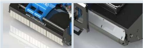
Protezione anteriore con bandelle in acciaio.
