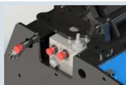
Fluidbox per una completa e sicura gestione del motore con valvola di massima antiurto, sistema anticavitazione e regolazione di flusso per settare correttamente il numero di giri del rotore.
