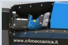
Motore a pistoni in posizione superiore e interno alla macchina per proteggerlo da urti e detriti. Prolunga motore su cuscinetti per evitare una prematura usura. Trasmissione a cinghia con rapporto 1:1 per massimizzare la potenza trasmessa, grazie alla funzione di giunto elastico che permette di preservare sia il motore che il rotore da sollecitazioni impreviste.
