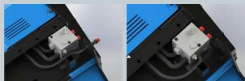
La macchina esce di serie in configurazione a due tubi, la fluidbox si occuperà di gestire il flusso di olio proveniente dal drenaggio del motore. Nel caso in cui la contropressione allo scarico sia maggiore di 8 bar è possibile prevedere il terzo tubo di drenaggio per lo scarico diretto in serbatoio.
