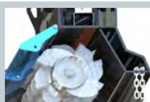
Cassa di spessore generoso per incrementare la robustezza e ottimizzare il volume di taglio. Rivestimento interno in Hardox.
