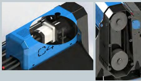
Motore idraulico a ingranaggi di serie, protetto da carter nel caso di urti e montato su prolunga con cuscinetti per evitare una prematura usura. Disponibile come **optional**: motore a pistoni. Trasmissione a cinghia, indispensabile per applicazioni dove le potenze trasmesse iniziano a diventare consistenti, grazie alla funzione di giunto elastico che permette di preservare sia il motore che il rotore da sollecitazioni impreviste.
