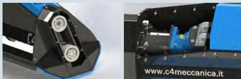
Motore a pistoni in posizione superiore e interno alla macchina per proteggerlo da urti e detriti. Prolunga motore su cuscinetti per evitare una prematura usura. Trasmissione a cinghia con rapporto 1:1 per massimizzare la potenza trasmessa, grazie alla funzione di giunto elastico che permette di preservare sia il motore che il rotore da sollecitazioni impreviste.
