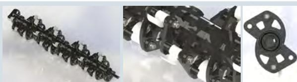
Particolare configurazione aperta del rotore, con mazze a scomparsa per ridurre pesi ed inerzie. I supporti mazza sono alleggeriti e sagomati per ridurre al minimo gli impatti con sassi e oggetti imprevisti.
